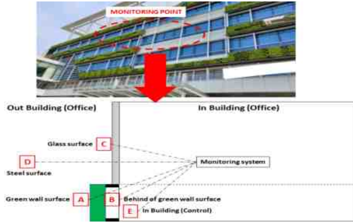
[ 그림 1 ] 일산서구청 벽면녹화 온도 모니터링 지점
