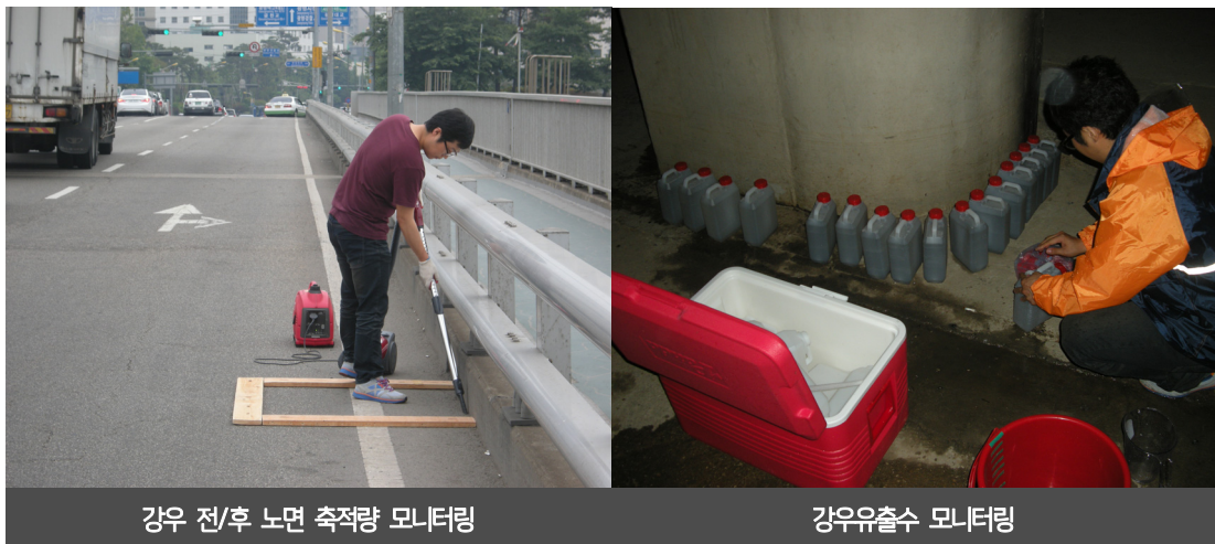
[그림 3-11] 도로 비점오염물질 강우유출량 모니터링 현장 모습
