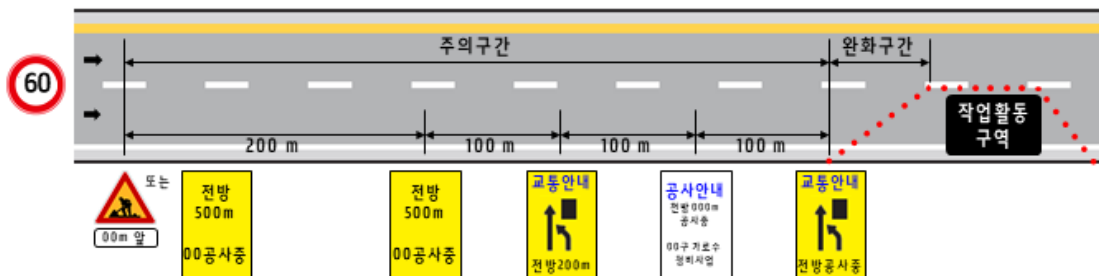
[그림 4-8] 고정 공사 시 교통안전표지 설치 기준
