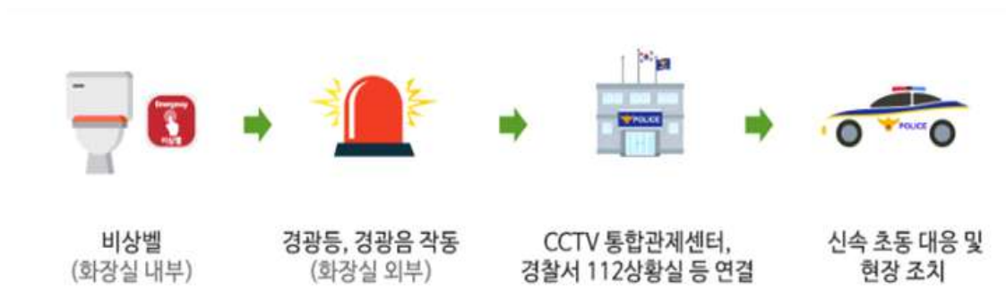
[그림 5] 경기도 화장실안심 비상벨 경보대응 시스템 체계도
